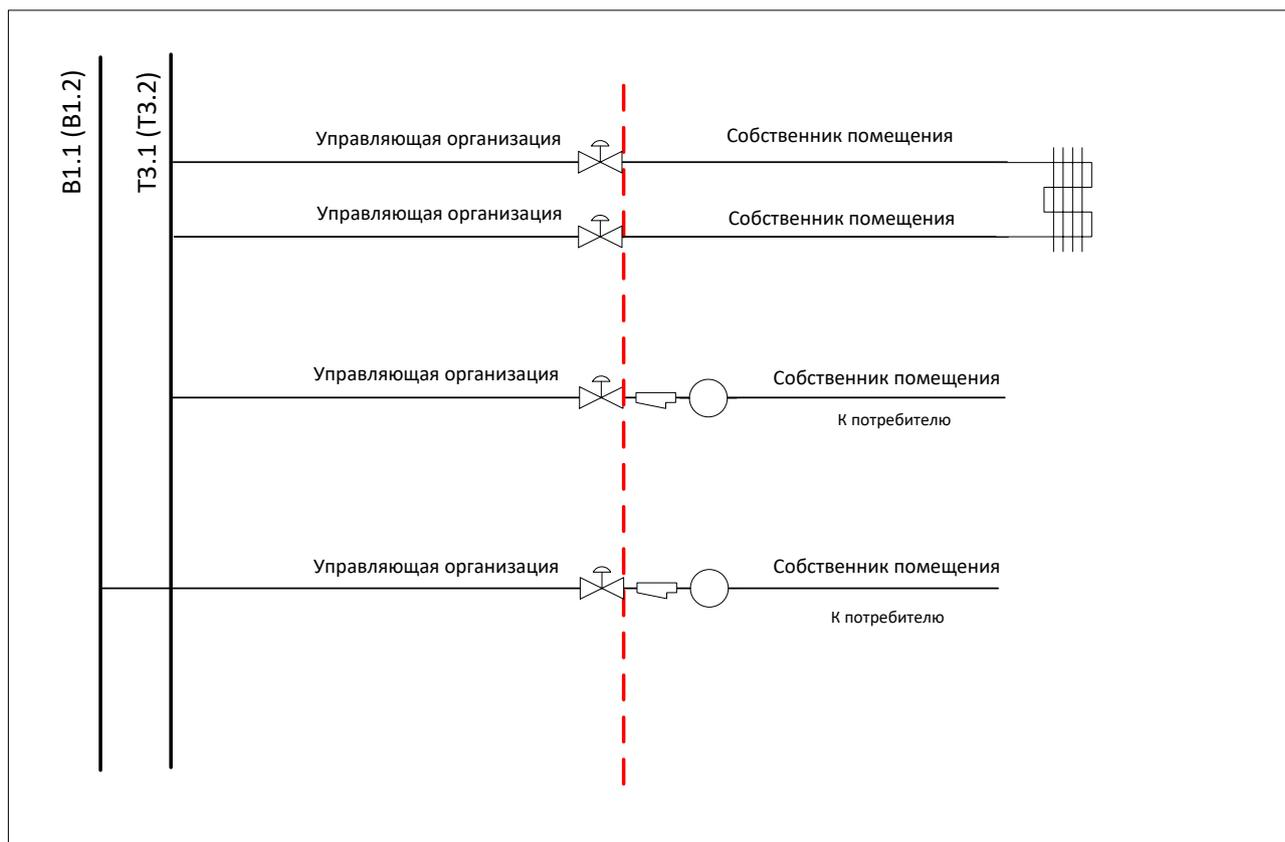
Управляющая организация не несет ответственности за техническое состояние водопроводной разводки с сантехническим оборудованием внутри помещения собственника.
